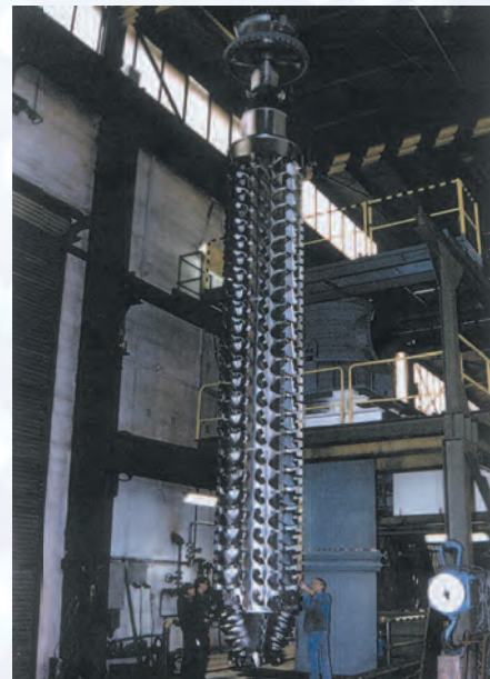
FILMTRUDER® - ротор на испытательном стенде
