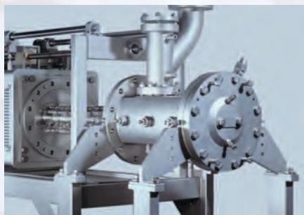
Арендный реактор большого объема периодического действия
